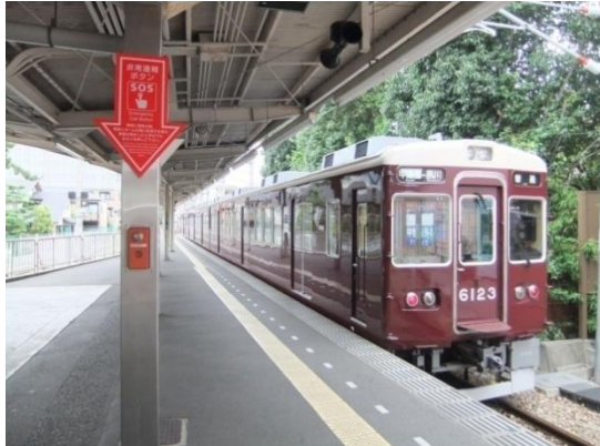
写真4「ホーム上の非常通報ボタン（転落支障報知装置）と阪急甲陽線ワンマン列車」 (2010年8月24日、夙川駅にて)
