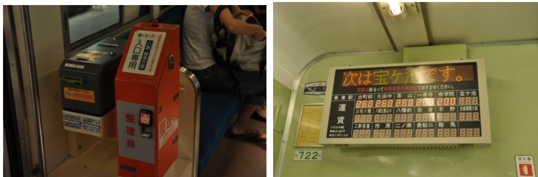
写真 4,5 「700 系の整理券発行機とカードリーダー (左)、運賃表示器 (右)」
