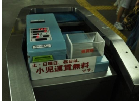
写真 13.14 「山ノ内駅の安全地帯（左）、帷子ノ辻駅の運賃回収機およびスルッと KANSAI 用カードリーダー（右）」
