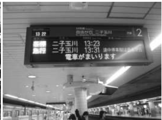
写真4「電光掲示板による列車接近表示」 (2008年8月18日、大岡山駅、筆者撮影)
